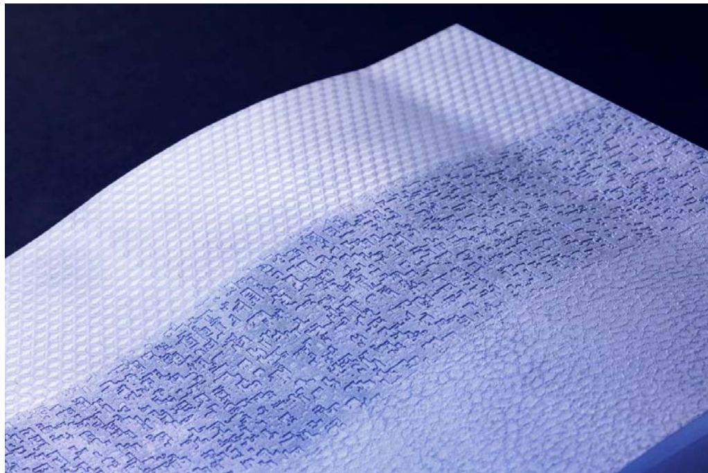
Laserstrukturierter Formeinsatz für das Kunststoffspritzgießen von Bauteilen zur Innenausstattung von Mittelklassewagen
