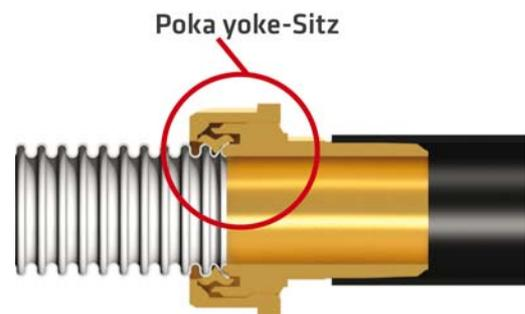
Das besondere an diesem System ist, dass die Verbindungen so konstruiert sind, dass bei der Montage praktisch keine Fehler auftreten können. Das Rohr wird einfach in den Verbindungen gesteckt, die Überwurfmutter angezogen und schon ist die Verbindung dicht.
