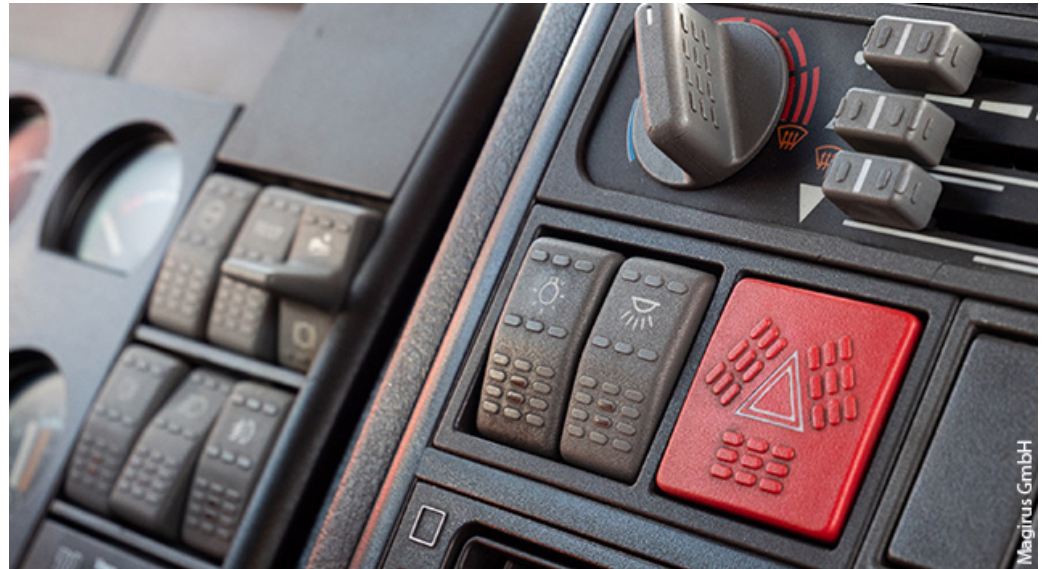
Der Kipp-Lichtschalter in der Mitte des Armaturenbrettes im Fahrerhaus
