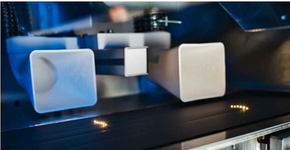
12 von 24 Teilstrahlen im Einsatz: Die Optik von Pulsar Photonics strukturiert das 300 mm breite Band der Batterieanode und verbessert so Leistungsdichte und Ladefähigkeit.
