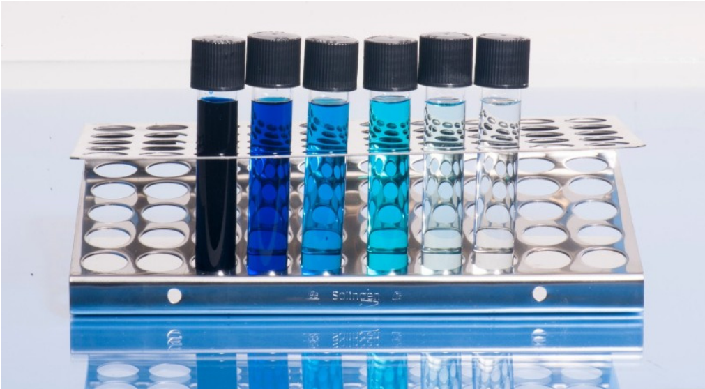
Prozessmonitoring durch selektive radiochrome Flüssigdosimeter
