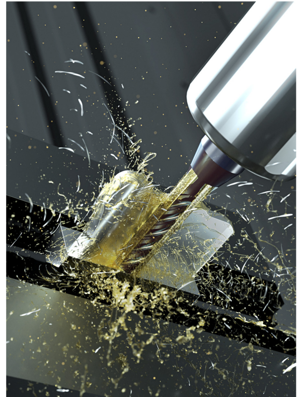
Kosteneffizientes Zerspanen aus dem Vollen von unlegiertem Titan.
