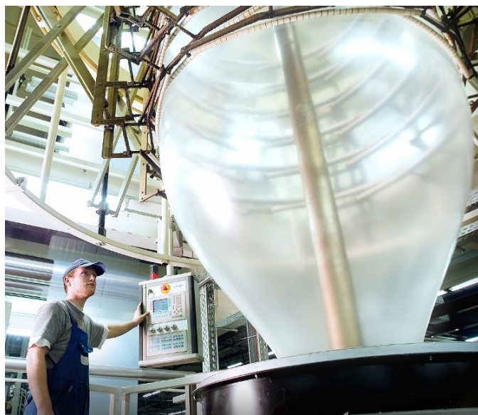
Die im Rahmen des RUBIO-Projekts entwickelten Biokunststoffrollen aus PBS sind recyclingfähig, biologisch abbaubar und können auf gängigen Extrusionsanlagen verarbeitet werden.
