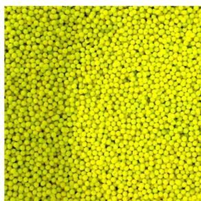
In den meisten Fällen kommen Rührprozesse zum Einsatz („Perlpolymerisierung“). Diese haben aber – neben der limitierten Skalierbarkeit – das Problem, dass in der Regel eine breite Kornverteilung produziert wird. Polymerpartikel zu sieben ist allerdings sehr aufwendig und ineffizient.
