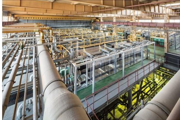
Zellensaal mit Elektrolyseuren am Standort von Russlands erster Chlor-Alkali-Elektrolyseanlage mit Membrantechnologie in Sajansk, Oblast Irkutsk
