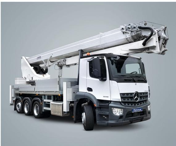
*Der Autokran AK 52 als 4-Achser in der 32 t-LKW-Klasse mit einer maximalen Nutzlast von 12 t, einer Ausfahrlänge von 52 m (optional 55 m) und unglaublichen Reichweiten*
