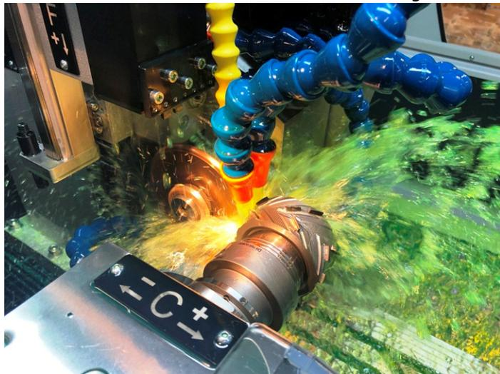
*Extrem achswinkliger Dia-Fügefräser beim Schärfen***Bild: LACH DIAMANT**
