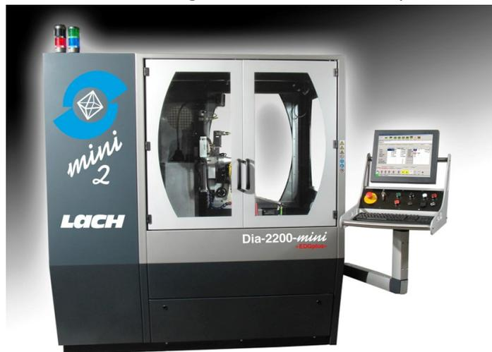
universale 5-CNC-Achsen-system ist auf den automatischen Schärfbetrieb von Dia-Werkzeugen bzw. -Sägen bis zum Durchmesser von 530 mm ausgelegt.
