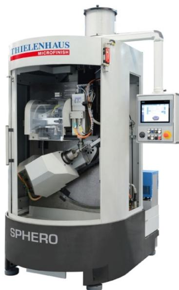
Durch den integrierten 10-fach-Werkzeugwechsler können komplexe Bearbeitungsprozesse in nur einer Aufspannung ausgeführt werden. Der Bedeinereinfluss ist dabei auf ein Minimum reduziert.
