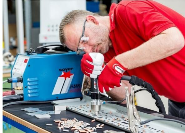
Die neuen tragbaren Bolzenschweißinverter BMS-9 ACCU und BMK-8i ACCU sind Leichtgewichte unter den Bolzenschweißgeräten, die freies Arbeiten ohne Netzkabel ermöglichen. Mit einem Gewicht von nur 6,6 kg bzw. 8,0 kg bieten beide Geräte höchste Flexibilität bei optimaler Energieeffizienz.
