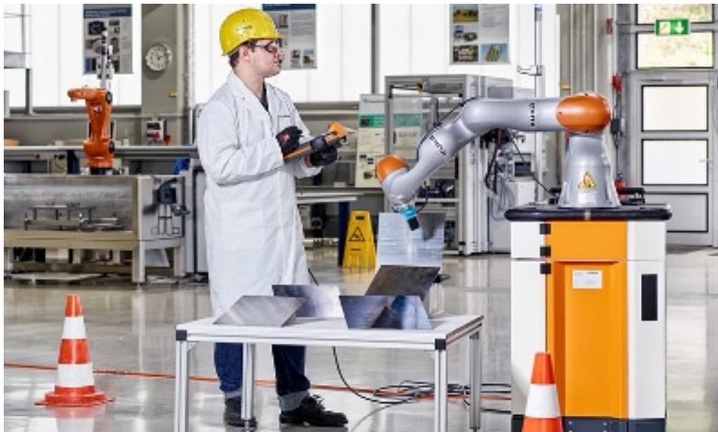
Durchführung einer robotergestützten Prüfung von Bandstahl. Untersucht werden mechanische Eigenschaften (Eigenspannungen) mittels mikromagnetischer Verfahren (3MA).
