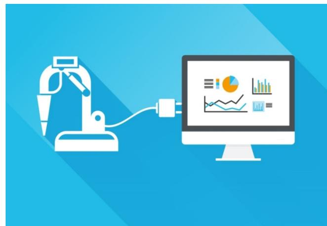
Datenschnittstelle, das ist die Aufgabe von FactorE.OS. Aus den Strom- und Spannungsaufnahmen an der elektrischen Zuleitung werden per Mustererkennung die Betriebszustände, Fertigungsschritte und Produkte erkannt, die gerade gefertigt werden.
