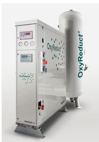
Hinter der Technik von OxyReduct® steht der clevere Lösungsansatz, einen Brand erst gar nicht entstehen zu lassen. Dafür wird der Sauerstoffgehalt im zu schützenden Bereich unter die Entzündungsgrenze der dort vorherrschenden Materialien dauerhaft abgesenkt und kontrolliert auf diesem Niveau gehalten. Der zur Sauerstoffreduktion benötigte Stickstoff wird bedarfsgerecht vor Ort aus der Umgebungsluft generiert.
