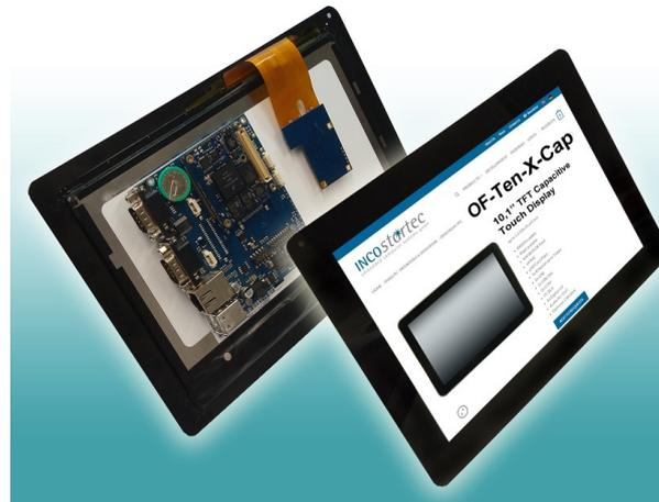
großen Angebot möglicher / passender Prozessormodule, basierend auf den Standard LILLY- und pLILLY- SoM Modulen. Darüber kann Leistungsanforderung je nach Anwendung vom ARM11/532MHz bis hin zum Cortex A8 und A9 mit bis zu 1,2 GHz angepasst werden.
