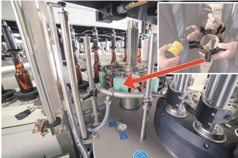
Gummierte Beleimungs-paletten erhalten über eine Leimwalze einen hauchdünnen Leimfilm und die Etiketten, die sie an Greiferzylinder übergeben. Diese wiederum setzen die Etiketten auf die Behälter auf. Um die Präzision dieses Vorgangs gewährleisten zu können, werden die Greiferzylinder mittels Schieber über Schieberführungen geleitet.
