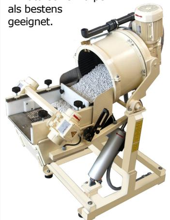
Die bedarfsgerecht modifizierte Kompakt-Fliehkraftgleitschliffanlage FKS 04.1 E-SA zum Entgraten von 18 mm großen Platten.
