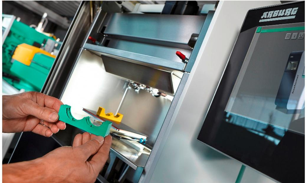
*Industrielle additive Fertigung: Mit dem Freeformer und dem Arburg Kunststoff-Freiformen (AKF) lassen sich funktionsfähige Bauteile effizient aus qualifizierten Standardgranulaten und ohne Werkzeug herstellen.*
