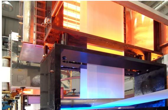
*UV-Strahlung härtet, Infrarot-Wärme trocknet - Tests in Anwendungszentren helfen die Parameter dafür zu bestimmen.*
