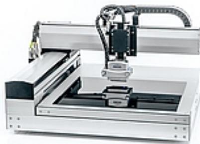
Das System bestimmt schnell und vollautomatisch die freie Oberflächenenergie großer Proben an beliebiger Position. Aufgrund der einfachen Handhabung und Programmierung ist diese robotergestützte, wissenschaftliche Oberflächenanalyse besonders für die Qualitätssicherung gereinigter, vorbehandelter oder beschichteter Materialien geeignet.
