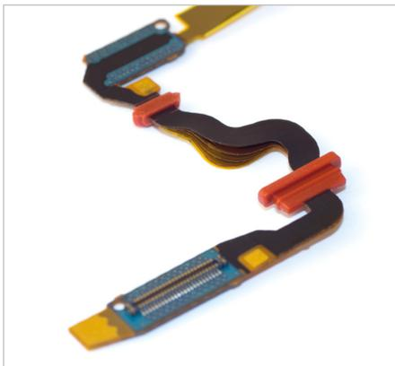
Mehrlagige flexible Leiterplatte mit Abdichtungsfunktion und Bestückung.
