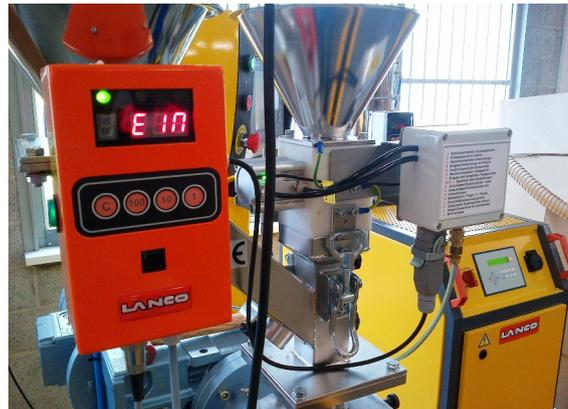
Traditionelle Verfahren wie volumetrische und gravimetrische Dosierung von Rohstoffkomponenten und Additiven sind häufig überfordert oder zu teuer wenn es um geringe Durchsätze und Zugabemengen von nur wenigen Prozent geht. Gravimetrische Geräte sind wegen des statischen Wägeprinzips, das allein auf Schwerkraft basiert, nur schwer auf Maschinen einsetzbar die sich ständig bewegen und wo Erschütterungen unvermeidbar sind.
