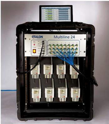
Etalon präsentiert absolut messendes Interferometer mit bis zu 100 Kanälen
