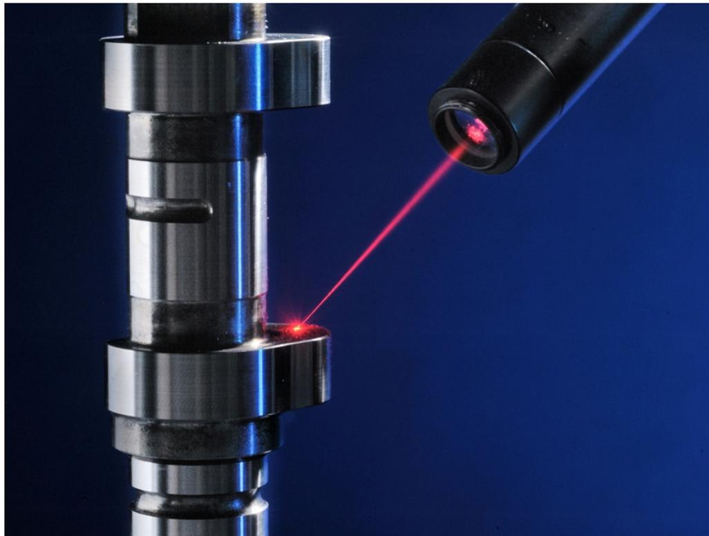
Form und Rauheitsmessung an einer Nockenwelle mit dem Sensor „bd-1“.
